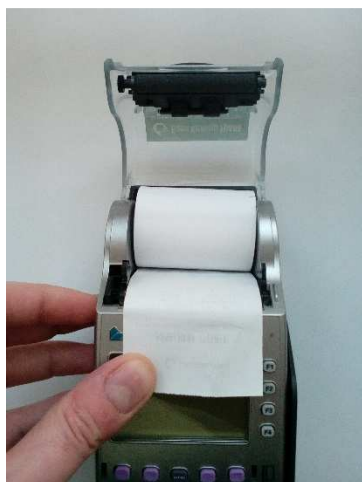
Рисунок 4. Загрузка рулона в лоток принтера
