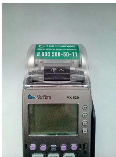
Рисунок 3. Открытие крышки отсека для бумаги
